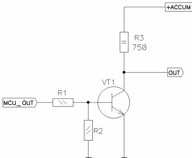
**Выходной каскад с открытым коллектором при питании схемы от аккумулятора и двухполярным сигналом (синусоида/меандр)**
