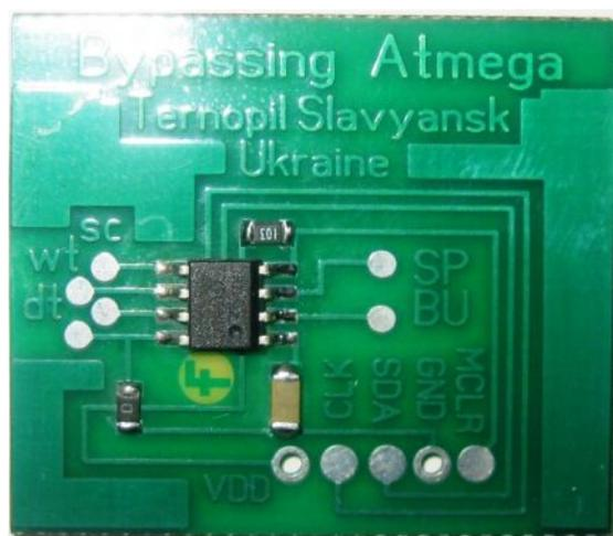
22. Переходник «адаптер» Soic8-DIP8. Двухсторонний контакт на soic, DIP- квадратное сечение.
